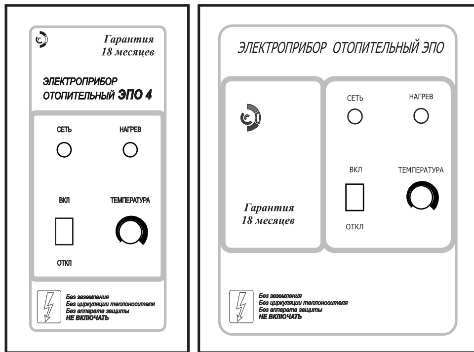
Рисунок 3. Пульты управления ПУ ЭПО-М1-4 и ПУ ЭПО-М1-6-30
